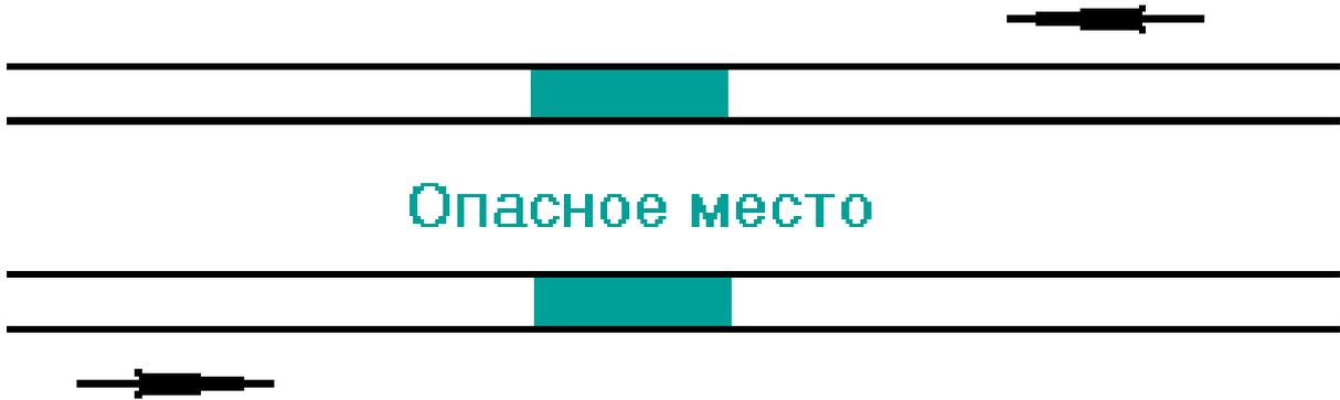
2. Вычертите схему ограждения грузового поезда, остановившегося на перегоне двухпутного участка в следствии развала груза с нарушением габарита по соседнему пути. Расстояние от места развала груза до головы остановившегося поезда 250 метров.
