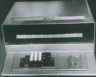
„ВЕГА“. Автоматически выполняет 10 вычислительных операций и имеет люминисцентный индикатор результатов. Быстродействие по арифметическим операциям—1 сек. (Изготовитель—Курский завод „КЗСМ“).
