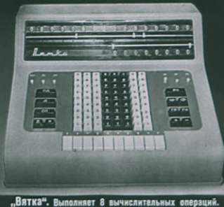
„Вятка“. Выполняет 8 вычислительных операций. Техническая скорость—300 циклов в мин.
