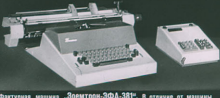
Фактурная машина „Земтрон-3ФА-381“. В отличие от машины „Земтрон ФМЕ“ имеет вместо механического электронное арифметическое устройство. Ширина каретки—320 мм. Скорость заполнения ведомостей—15 знаков в сек. (Изготовитель—ГДР).
