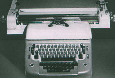
Фактурная машина „ФМЕ“. Производительность—95-100 строк в час. (Изготовитель—ГДР).
