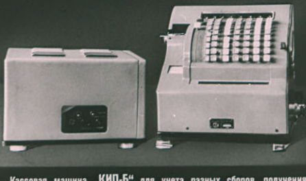
Кассовая машина „КИП-Б“ для учета разных сборов, получения перфоленты с последующей дистанционной передачей сведений. (Изготовитель — Рязанский завод „САМ“).
