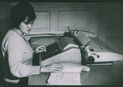
Бухгалтерская машина „Аскота-170“ Имеет до 55 счетчиков и дает возможность за один рабочий прием получить готовые сводные многографные ведомости. Производительность машины—135 циклов в мин. (Изготовитель—ГДР).
