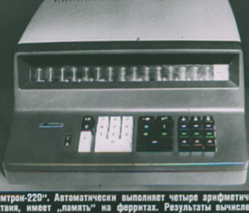
„Земтрон-220“. Автоматически выполняет четыре арифметические действия, имеет „память“ на ферритах. Результаты вычислений—на цифровых индикаторных лампах. Время сложения (вычитания)—5 миллисек., умножения (деления)—0,5 сек. (Изготовитель—ГДР).
