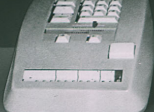
Малогабаритная вычислительная односчетчиковая десятиклавишная машина „Быстрица“. Выполняет четыре арифметические операции со скоростью 300 циклов в мин.
