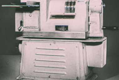
Маркировальная машина „ММ-48“. Наносит на конверт знак, заменяющий почтовую марку, календарный штампель, наименование станции, ее почтовый адрес и порядковый номер отправления. Производительность — 2000 оттисков в час.
