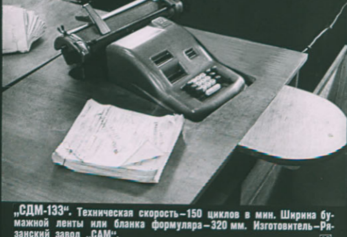
„СДМ-133“. Техническая скорость—150 циклов в мин. Ширина бумажной ленты или бланка формуляра—320 мм. Изготовитель—Рязанский завод „САМ“.
