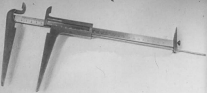
Штангенциркуль с удлинёнными лапками для измерения износа рамного рельса и остряка, а также ширины желобов в стрелке и крестовине.
