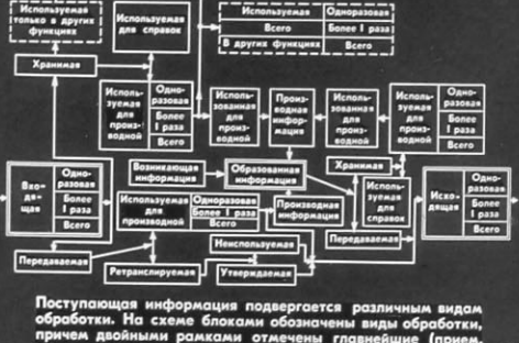
Поступающая информация подвергается различным видам обработки. На схеме блоками обозначены различные виды работ, причем двойными рамками отмечены главнейшие (прием, образование и передача информации).
